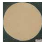
HC-60 侵食度 5.3µm/h 流速 1.8m/s
